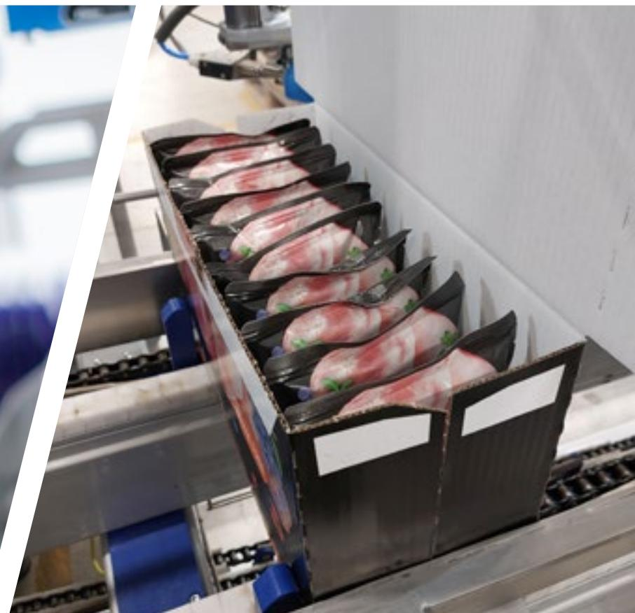
Wrap Around Hochleistungspacker für bis zu 40 Verpackungseinheiten pro Minute. Die modulare Bauweise gewährleistet einen effizienten, zuverlässigen und flexiblen Betrieb, mit einfachen Formatwechseln und optimaler Zugänglichkeit für Wartungen. Speziell für flexible Primärverpackungen.
